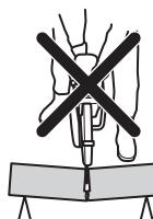
Pokud dojde k zaseknutí kotouče v zóně zpětného rázu, reaktivní síla rozbrušovací pilu vymrští směrem nahoru a zpět k uživateli rotačním pohybem způsobujícím vážné nebo dokonce smrtelné zranění. Mějte se na pozoru před možným pohybem zpracovávaného dílu. Pokud není zpracovávaný díl rádně podepeněn a při řezání se posouvá, může přiskřípnout kotouč a způsobit zpětný ráz.
