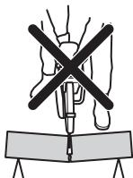
Jeżeli tarcza zaciśnie się lub zaklinuje w strefie odbicia, siła reakcji pchnie przecinarkę do góry i do tyłu w stronę użytkownika w ruchu obrotowym, powodując poważne lub nawet śmiertelne obrażenia. Uważnie obserwuj potencjalne ruchy ciętego materiału. Jeżeli materiał cięty nie został prawidłowo podparty i przesuwa się podczas cięcia, może nastąpić zaciśnięcie tarczy i odbicie.
