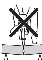
Ak sa kotúč zasekol alebo uviazol v zóne spätného nárazu, reakčná sila rotačným pohybom vyhodí rozbrusovaciu pílu dozadu smerom na používateľa a môže spôsobiť vážne alebo dokonca smrteľné zranenie. Dávajte pozor na potenciálny pohyb obrobku. Ak obrobok nie je pevne podopretý a pri rezaní sa posunie, mohol by zovrieť kotúč a spôsobiť spätný náraz.
