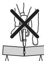
Ha a korong a visszarúgási zónában csípődik be vagy akad el, a gép a reakcióerő hatására forgó mozgással felfelé és hátra dobódik, a felhasználó felé, és így súlyos, akár halálos sérülést is okozhat. Legyen elővigyázatos, ha a munkadarab megmodzul. Ha a munkadarab nincs megfelelően megtámasztva, és vágás közben eltoldódik, becsípetheti a pengét, ami visszarúgást okozhat.
