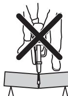
Pokud dojde k zaseknutí kotouče v zóně zpětného rázu, reaktivní síla rozbrušovací pilu vymrští směrem nahoru a zpět k uživateli rotačním pohybem způsobujícím vážné nebo dokonce smrtelné zranění. Mějte se na pozoru před možným pohybem zpracovávaného dílu. Pokud není zpracováváný díl rádně podepřen a při řezání se posouvá, může přiskřípnout kotouč a způsobit zpětný ráz.
