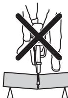
Ak sa kotúč zasekol alebo uviazol v zóne spätného nárazu, reakčná sila rotačným pohybom vyhodi rozbrusovaciu pílu dozadu smerom na používateľa a môže spôsobiť vážne alebo dokonca smrteľné zranenie. Dávajte pozor na potenciálny pohyb obrobku. Ak obrobok nie je pevne podopretý a pri rezaní sa posunie, mohol by zovrieť kotúč a spôsobiť spätný náraz.
