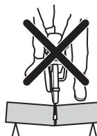
Jeżeli tarcza zaciśnie się lub zaklinuje w strefie odbicia, siła reakcji pchnie przecinarkę do góry i do tyłu w stronę użytkownika w ruchu obrotowym, powodując poważne lub nawet śmiertelne obrażenia. Uważnie obserwuj potencjalne ruchy ciętego materiału. Jeżeli materiał cięty nie został prawidłowo podparty i przesuwa się podczas cięcia, może nastąpić zaciśnięcie tarczy i odbicie.
