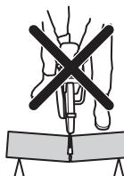
Ha a korong a visszarúgási zónában csípődik be vagy akad el, a gép a reakcióerő hatására forgó mozgással felfelé és hátra dobódik, a felhasználó felé, és így súlyos, akár halálos sérülést is okozhat. Legyen elővigyázatos, ha a munkadarab megmodzul. Ha a munkadarab nincs megfelelően megtámasztva, és vágás közben eltolódik, becsípheti a pengét, ami visszarúgást okozhat.
