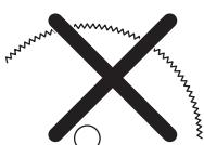
Používanie kotúčov s karbidovými hrotmi s touto rozbrusovacou píľou je porušením pracovných bezpečnostných predpisov.
